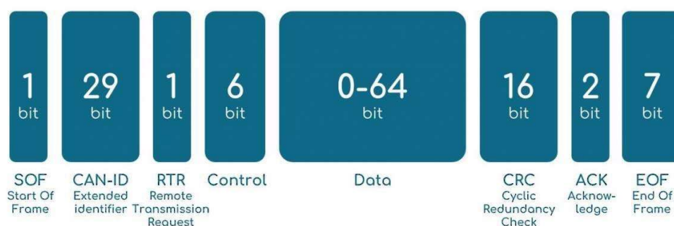
FIGURE 2.4 – Structure d'une trame CAN avec identifiant étendu
